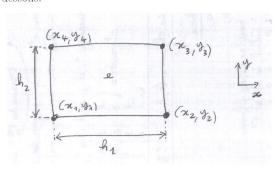
On muni e de l'élément fini de Lagrange  $Q_1$  et on note  $\{N_1^e,\dots,N_4^e\}$  sa base d'interpolation.
